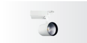
Iluminación de acento o general Ópticas 10°, 24° y 45°. Atenuable 0-10 V. Luminaria versátil con accesorio recortador opcional.
