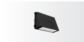
WALLPACK CCT 192 Luminaria para fachadas exteriores IP65. IK 08. Óptica tipo III. Flujo luminoso 13,000 lm. TCC 3000K, 4000K y 5000K.
