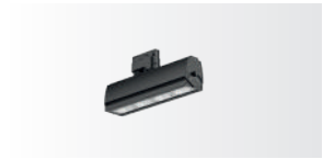
WALLTRACK 128 Efecto wall washer con óptica 30°x60°. IRC 90. Giro de 360° Para lograr una bañado uniforme, basta con montarlos a 1 m de distancia del muro y entre cada luminario.
