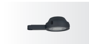
URBAN CITY 237 Iluminación para vialidades IP65. IK10. Óptica tipo II M. Haz de luz medio que permite abarcar mayor área por luminario.
