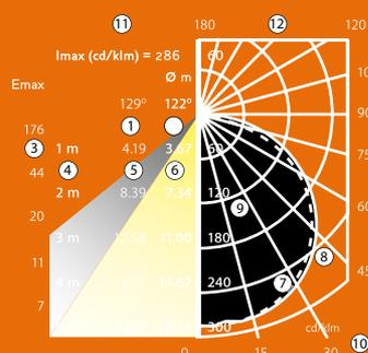
1) Ángulo de apertura del haz al 50% en plano vertical longitudinal.
